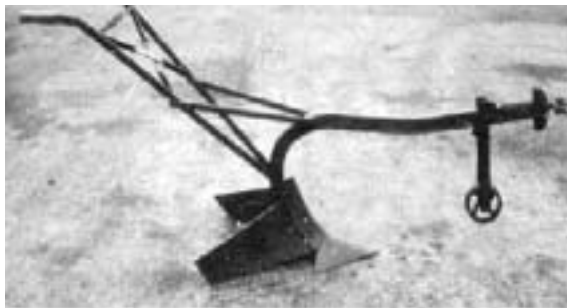
Figura 44: A charrua de amontoa Agrimal pesa 44kg; as asas são ajustáveis.
