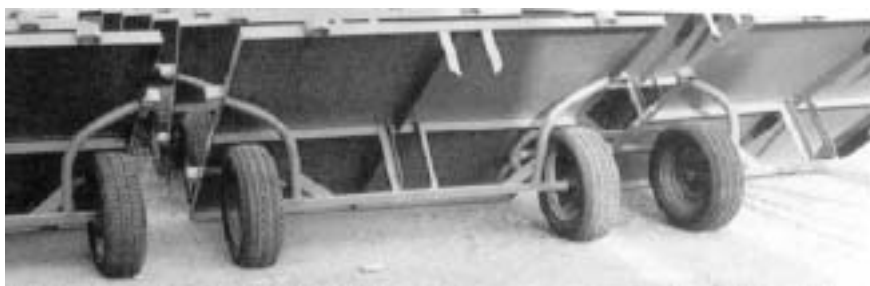
Figura 30: Carroças de duas rodas usando rolamentos e pneus rejeitados na fábrica. Concebidas para uma junta de bois, mas no Togo utiliza-se um tamanho pequeno para um único burro.
